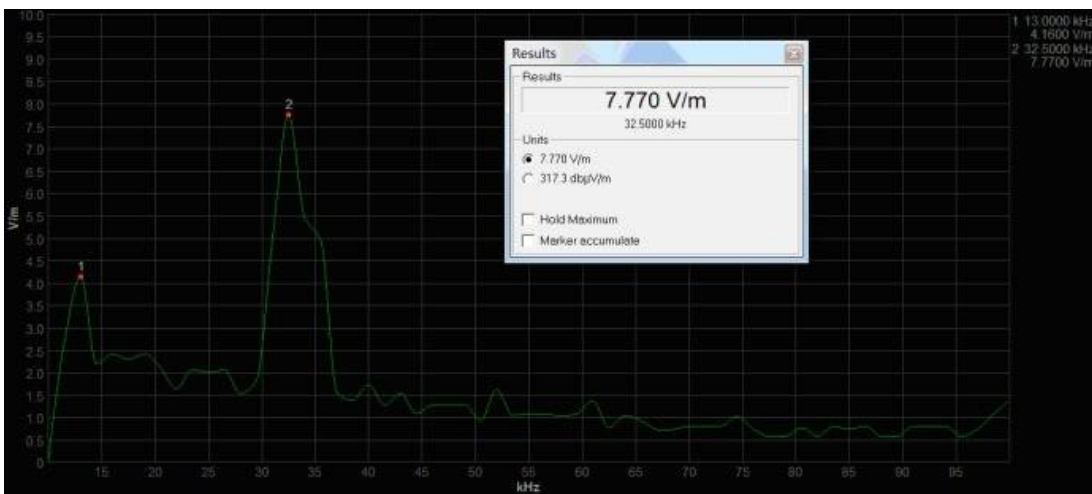
上图为在电磁炉没有启动的情况下，现场背景噪声，电场最大值为 7.770V/m(32.5kHz)。
