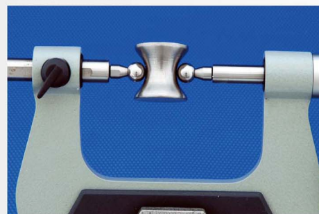
测量异形零件根部尺寸
