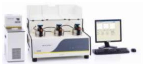
济南兰光包装安全检测中心依据此标准，对多个厂家的用于加工轮胎气密层的硫化橡胶片材进行了透气性
