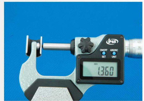
测量异型零件根部尺寸
