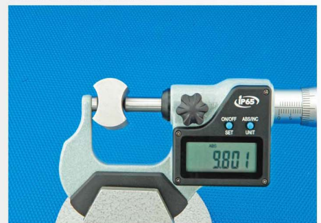
测量异型零件根部尺寸
