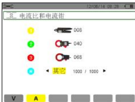
图 5-8 电流钳及变比设置菜单
