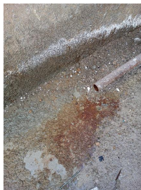
2014. 8. 28 投用 锅炉排污管排出的垢锈物 山西运城晋骏新材料有限公司
