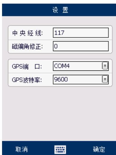
在系统参数设置界面中，可以对中央经线、磁偏角修正、GPS 端口和 GPS 波特率进行设置，设置完成后点击“确定”按钮，即完成设置。
