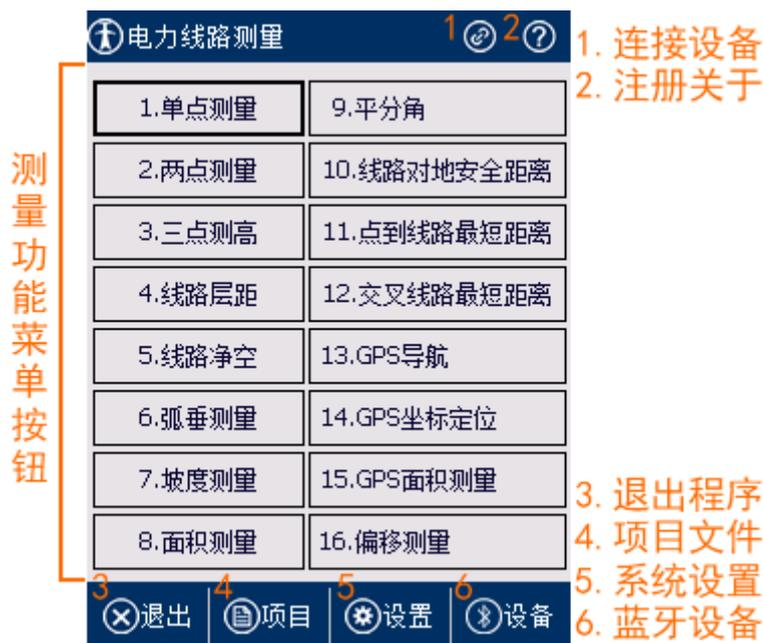
主界面中顶部状态栏，通过 1 与 2 状态按钮分别连接或断开设备和注册软件或查看软件信息；底部菜单栏，通过 3、4、5、6 菜单按钮分别可推出程序、新建或打开项目、系统设置和测距仪设备选项；中间有 16 种功能模式按钮，你可以选择进入响应模式来测量作业。
