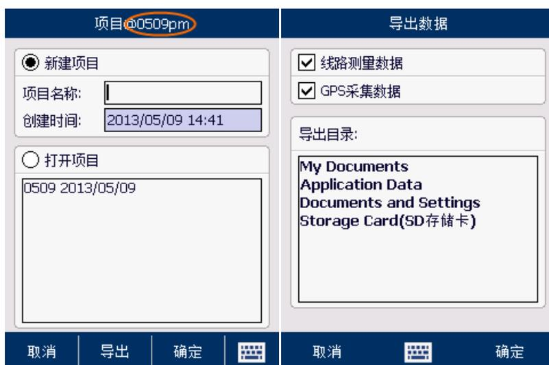
在项目界面中，如果已经指定了项目文件（新建或打开了某个项目），则在顶部标题上会显示当前所处的项目名称；选择“新建项目”单选框，输入项目名称，创建时间会自动生成为当前时间，然后点击“确定”按钮，即创建了一个新项目；选择“打开项目”单选框，在项目列表中选择个项目，点击“确定”按钮，即打开一个已经存在的项目；点击“导出”按钮，进入导出数据界面中，选择导出数据类型和导出目录后，点击“确定”按钮，即导出选择的数据。
