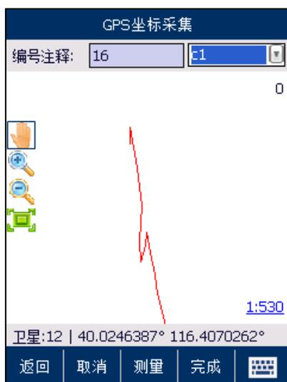
点击底部【完成】菜单按钮，即可完成航线采集，点击【取消】将放弃当前航线的采集。
