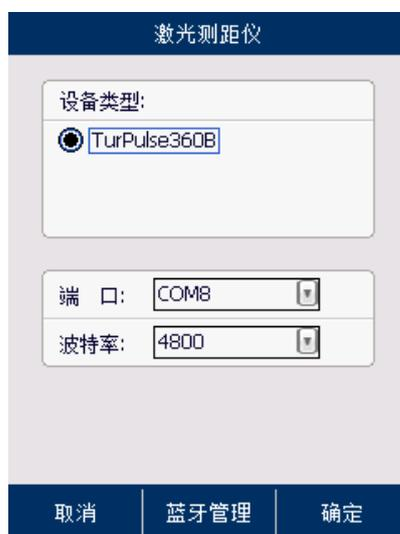
激光测距仪界面中，选择激光测距仪的设备类型、端口和波特率，然后点击下方的“蓝牙管理”按钮，进入蓝牙设置界面：
