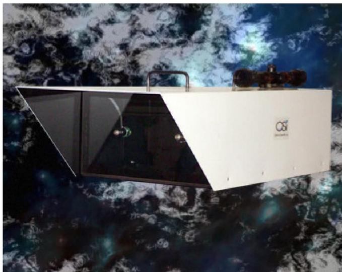
长基线光学风速计 (LOA™) 是用来测量空气的风和湍流。其平均距离可达到 100 米，甚至 10000 米以上。基于光学闪烁技术，该设备测量的光学值随着当前温度和密度的变化而变化。在测定风力方向的应用程序中，两个系统会以“X 模式”设置出来。通过围绕三个或更多的首尾相连的链接，也能测出垂直型组件。此设备能在各种天气状况下真实测量出狂风和湍流。
