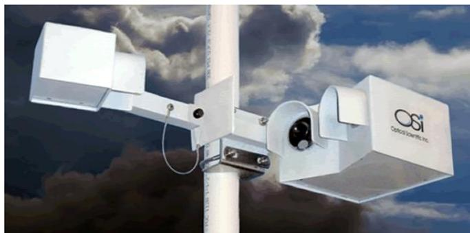
OWI-650 LP-WIVIS™ 现在可以作为光科学股份公司的风、温度/温湿相对度和气压传感器的数据采集系统，创建一个独立的自动气象站。从来没有一个自动气象站的天气和能见度能力能承担起这样的作用。只用安装 OWI-650 并将可选的传感器连接到 OWI-650 电源和接线盒。所有传感器信息和 OWI-650 的连续输出相结合。不需要其他数据采集系统。太阳能设备和数据广播选项可用。
