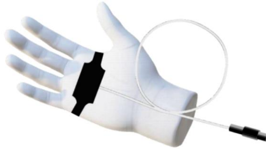
1a 振动传感器固定在作业工人手部
