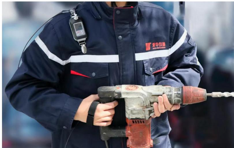
AWA5937 型手传振动测定仪采用数字信号处理技术的三轴向手传振动测量仪器可以同时测量多种评价指标具有多功能、高性能、体积小、低功耗、操作简单等优点适用于工厂企业、职业卫生、教学、科研等领域。
