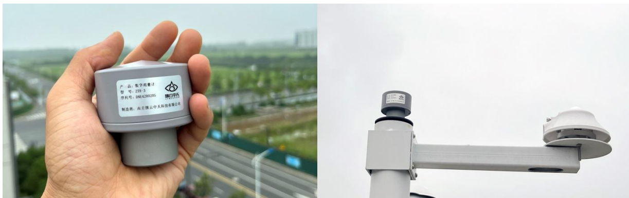
图 1. ZTR-3 数字雨量计实物图
