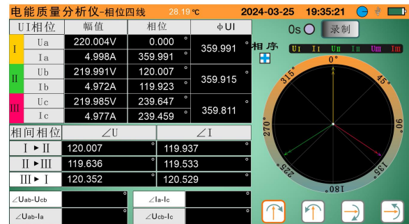
相位测量-三相四线测试界面
