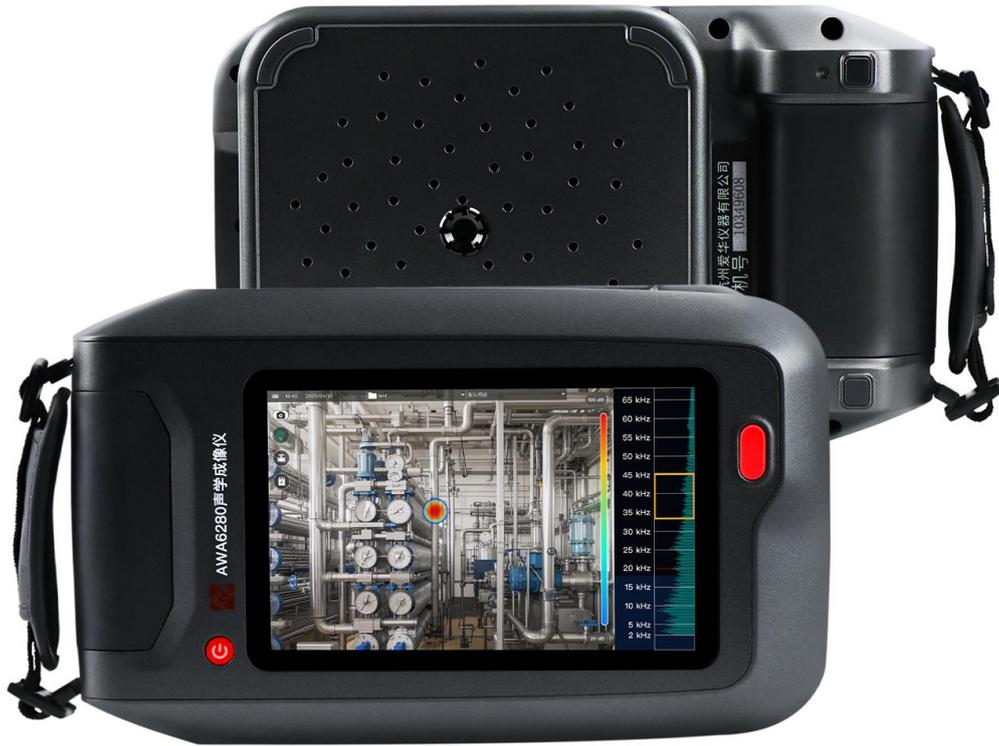
AWA6280 型声学成像仪是一款基于阵列波束成形技术和图声融合成像技术研发的手持便携式声学成像产品，利用高精度麦克风阵列和声源定位技术，能够快速、精准地定位声信号源，具备超声成像、泄露检测、PRPD 局放模式、声源识别等功能。
