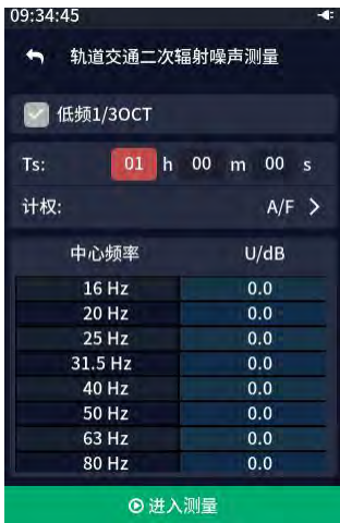
图 6-4-7-1 轨道交通二次辐射噪声测量
