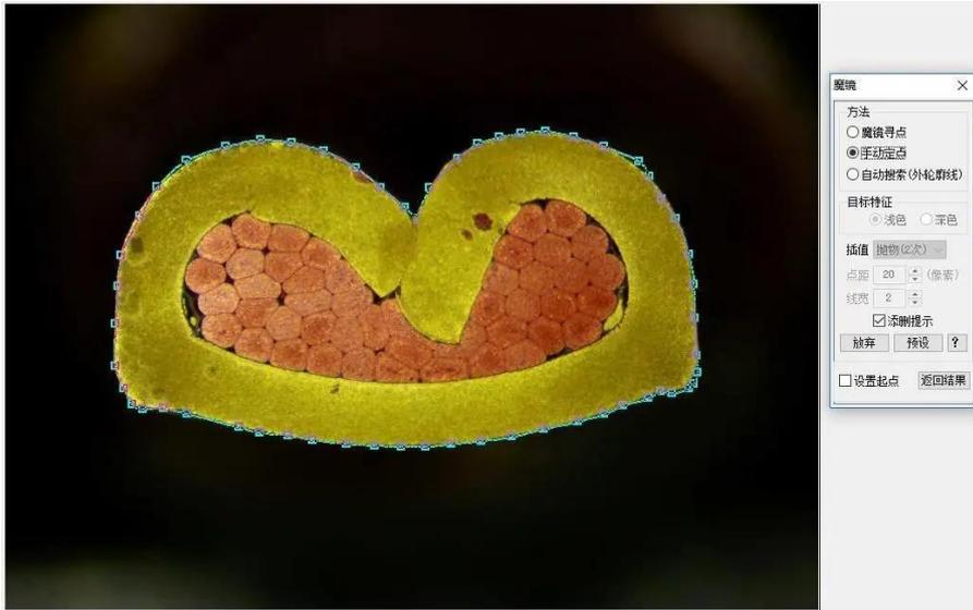
②全自动一键分析,即端子的各种参数可以快速一步分析完成,也可以任意切换到相关参数步骤进行调整和修改。
