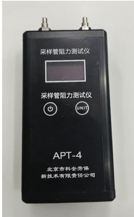
APT-4 采样管阻力测试仪是新一代数字式压差测量装置，采用高精度进口差压传感器，能快速准确的进行气体压差测量，相对于机械式压差计具有精度更高，使用更加直观便捷的优势。APT-4 采样管阻力测试仪具备如下优点：即开即用、软键开关；三种单位自由切换并自动换算；高分辨率 OLED 屏数字显示，读数更加直观方便；用户一键式校零，轻松消除零漂；模压铝制外壳，结实耐用；电池电量指示，仪器长时间空闲自动关机。本压差计适用于职业卫生、大气采样等场合采样介质阻力检测及各种采气泵、监控或采暖通风空调系统，洁净室或任何低压气体压力系统的压差测量。
