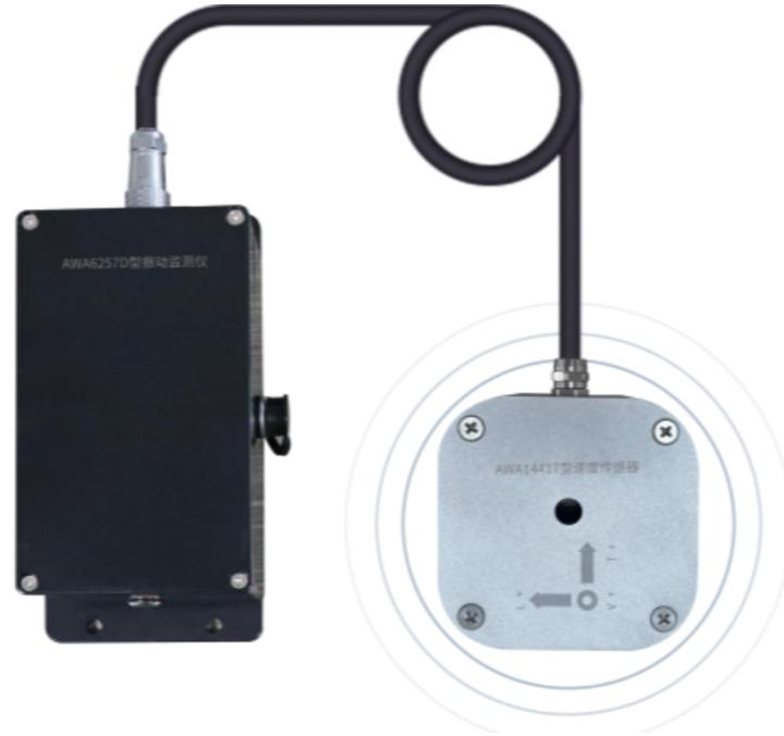
AWA6257D 型振动监测仪是针对爆破施工振动研制的三轴向速度测振仪，该仪器可通过 RS-232 串口将测试数据实时传输到接收端，也可以通过网络将测量数据传输至云服务器，实现爆破振动的网络化、系统化监测，既适用于个别点位现场检测，更适用于测点多、频次高、周期长的爆破振动监测项目，以监控施工作业造成的爆炸振动，也可以用于各种环境条件下的三轴向振动监测。
