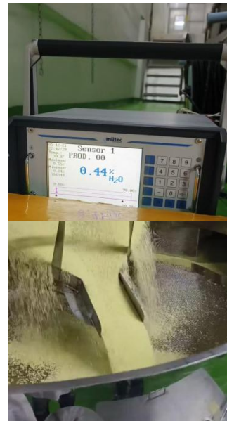
传感器用于物料流的连续性检测
