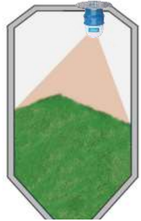
介可视·雷达全景扫描系统安装示意图
