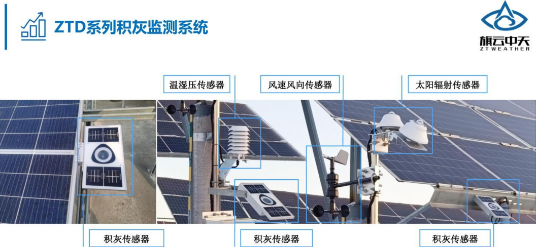
图 3. 积灰传感器安装示意图
