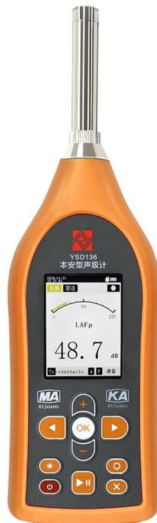
职业卫生噪声是指人们在工作场所长期暴露于噪声环境中，可能导致的人耳听力损伤和健康伤害。国家为了保护从业者的健康，制定了噪声允许标准 GBZ 2.2-2007《工作场所有害因素职业接触限值 第2部分：物理因素》。职业卫生噪声测量方法按 GBZ/T 189.8《工作场所物理因素测量 噪声》的要求，使用2级或2级以上声级计、积分声级计或个人声暴露计，需具有A、C计权和“Peak(峰值)”。固定岗位且有防爆要求的建议选用 YSD136 本安型声级计；无防爆要求时可选用 AWA6292 型、AWA5662 型声级计（1级）或 AWA5688 型、AWA5636-2 型声级计（2级）。
