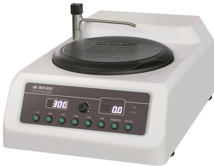
**M-1 pro+型金相试样预磨机**为单盘台式机，具有转动平稳、安全可靠、结构紧凑和噪音低等特点。本机带有水冷却装置，可以在研磨时对试样进行冷却，以防止因试样过热而破坏金相组织；适用于对金相试样进行粗磨、半精磨、精磨的制样，供进一步抛光后进行组织的显微测定，是企业、科研单位以及大专院校实验室的理想制样设备。
