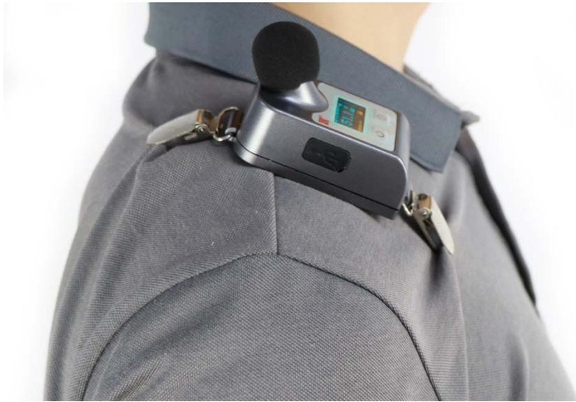
作为个人佩戴使用的测量噪声暴露量的仪器叫个人声暴露计，用于测量声暴露，即瞬时 A 频率计权声压平方的时间积分。其工作原理是“等能量交换率”，对于恒定声级，积分时间加倍（或减半），声暴露也加倍（或减半）；同样，对于恒定积分时间，输入声级增加（或减小）3 dB，声暴露将加倍（或减半）。GB/T 15952/IEC 61252《电声学 个人声暴露计》规定了它们的特性要求，只有一个准确度等级，相当于 IEC 61672.1 对 2 级积分声级计的要求。
