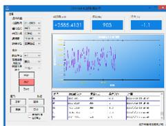
安装在计算机中与高斯计进行通信的软件，可用于测试数据的保存、导出和绘图等功
