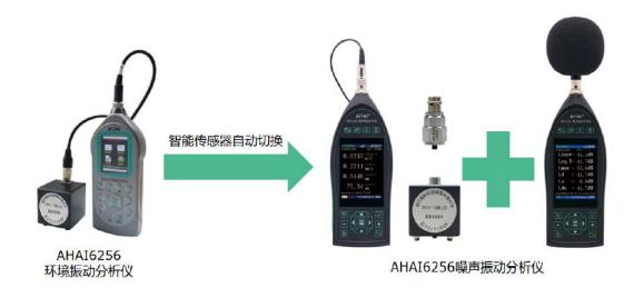
AHAI6256 型噪声振动分析仪是一种采用数字信号处理技术的手持式振动分析仪,它既能测量环境振动、全身振动. 手传振动,又可以测量设备振动;既能测量振动信号的加速度、速度、位移,又可以对振动信号进行 1/3 0CT 频谱分析,FFT 分析。是 AWA6256, AWA6256B+, AWA6291的更新换代产品。一台仪器就可以替代工作测振动、人体对振动的响应测量仪器、实时1/30CT 分析仪、FFT 分析仪、记录仪。
