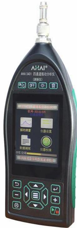
AHA13401 型四通道三轴向振动分析仪采用数字信号处理技术、模块化设计，它既能测量环境振动、全身振动、手传振动,又可以测量设备振动；既能测量振动信号的加速度、速度、位移，又可以对振动信号进行 1/3 OCT 频谱分析、FFT 分析。
