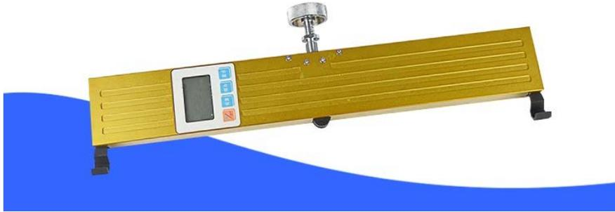
电梯绳索张力计主要应用于电梯曳引钢丝绳的张力测试。在电梯安装、验收和年检过程中，通过对每条曳引钢丝绳张力的测试调整，使其张力尽可能一致，从而延长曳引轮的使用寿命，并使电梯钢丝绳运行更加平稳。此张力计同时还可应用于桥用吊索、杆塔接线、架空导线、索引钢丝绳等涉及钢索张力的测试。
