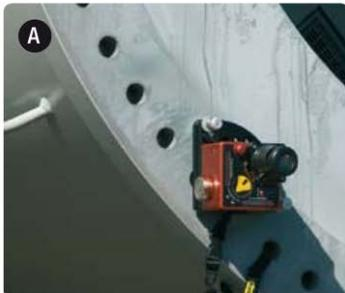
Easy-Laser® D23激光发射器直接吸附在法兰面上，它有一个自动旋转的激光发射头，这样就能产生连续的激光面。
