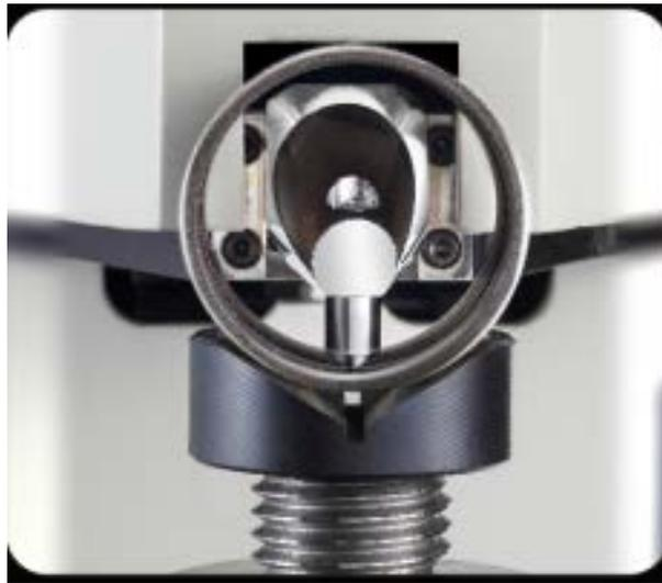
图 4. 可测量环状零件内孔
