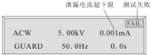
发出声光报警，报警指示灯闪烁，蜂鸣器发出“嘟——”长声。此时按停止键，可关闭报警声音，进入光报警，再按停止键，可回到待机态。
