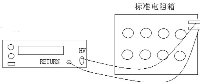
图 D.1.3 绝缘电阻检定示意图
