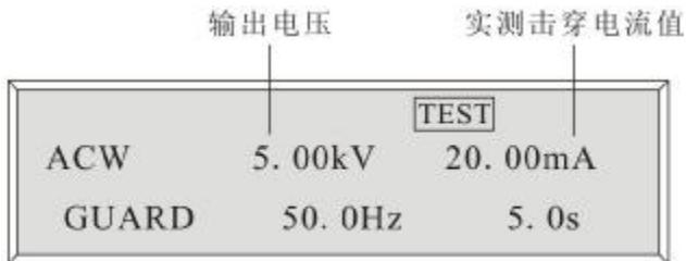
测试时，如果内部设置漏电流，屏上指示“INNER”闪烁。VFD 显示格式如下：
