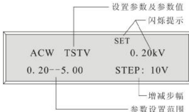
进入 ACW 参数设置状态后，首先进行输出电压的设置，显示格式如下，表示当前输出电压设置为 0.20kV，设置范围为 0.20~5.00kV，增减步幅 10V。
