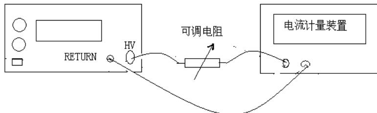
图 D.1.2 击穿报警电流值检定示意图
