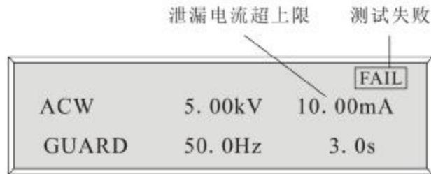
发出声光报警，报警指示灯闪烁，蜂鸣器发出“嘟-----”长声。此时按停止键，可关闭报警，回到待机态。
