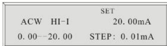
报警下限设置显示格式如下，表示当前电流报警上限为 0.00mA，设置范围 0.00~20.00mA，增减步幅 0.01mA。
