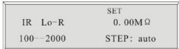
报警上限设置显示格式如下，表示当前绝缘电阻报警上限为 200MΩ，设置范围 0.00~2000 MΩ，增减步幅为 auto，即自动调整增减步幅。
