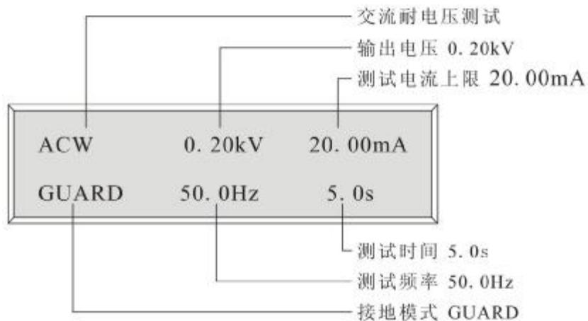
图 4.2.1 ACW 测试时待机状态
