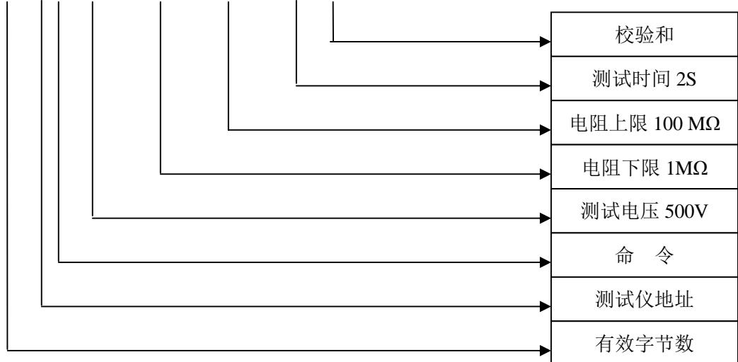
测试方式为 ACW，测试电压 1800V，电流上限 20 mA，电流下限 0.5mA，测试时间 2s，频率 50Hz，缓升 2s，缓降 2s，保留为 0。上位机发送命令格式：
