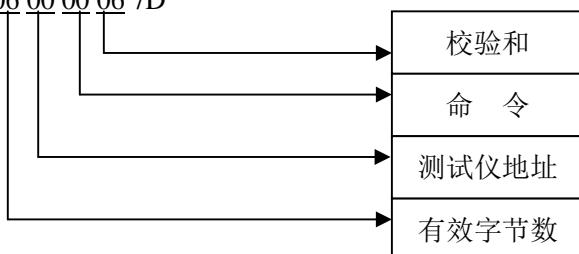
注释：当仪器处于测试，测试结束，报警状态时，可用此命令读取测试中的结果。
