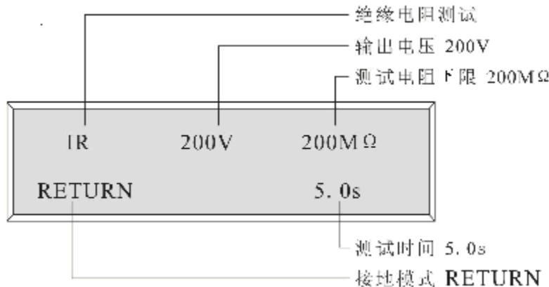
图 4.2.2 IR 测试时待机状态
