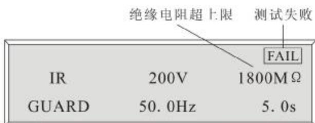
此时按停止键，可关闭报警声音，回到待机态。
