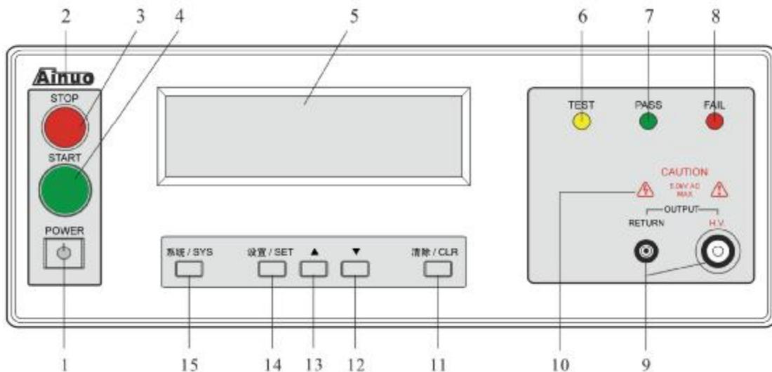
图 3.3.1 AN9632M 系列前面板示意图
