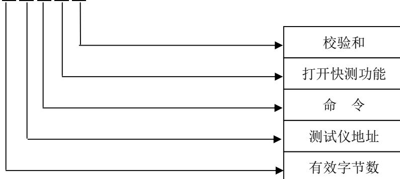
注释：当仪器处于待机状态时，可用此命令设置快测功能的打开、关闭。
