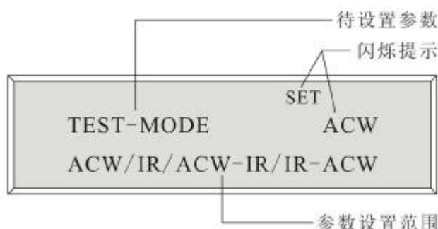
通过<增>键或<减>键可切换为绝缘电阻测试 (IR)、联合测试先交流耐电压测试后绝缘电阻测试 (ACW-IR) 或先绝缘电阻测试后交流耐电压测试 (IR-ACW)。
