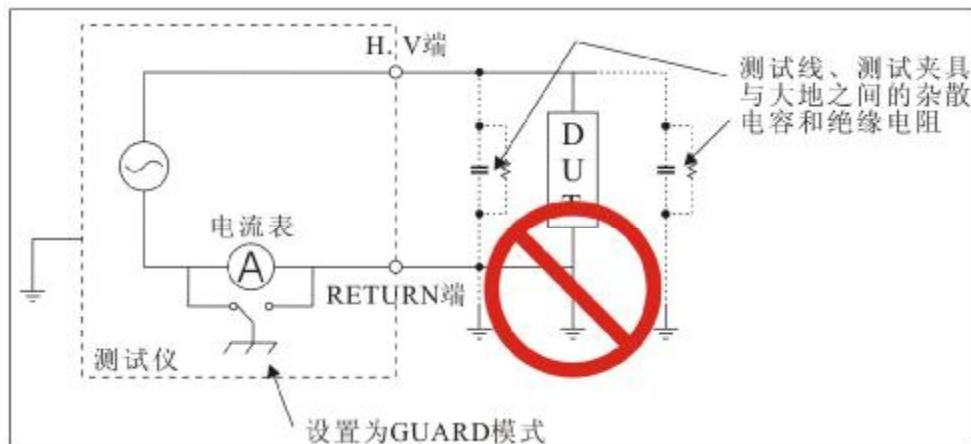
图 4.3.3 接地模式设置为 GUARD—DUT 接地
