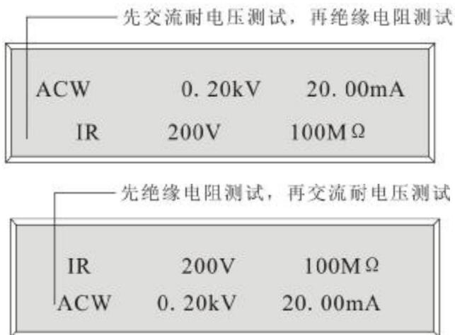
联合测试待机状态显示首测试步信息。
