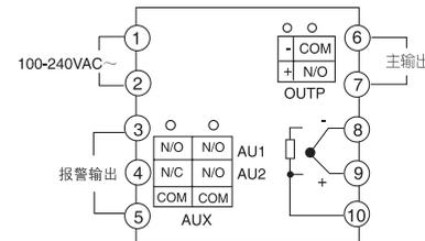
注 1: 热电偶应用补偿导线直接接入仪表后盖输入端子上, 中间不得转用普通导线连接, 并注意补偿导线型号与极性的正确。
