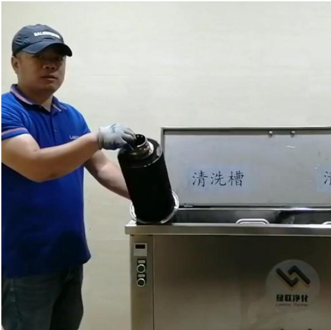
放入滤芯 → 超声波清洗 → 清水冲洗 → 压缩空气吹干 → 取出滤芯
