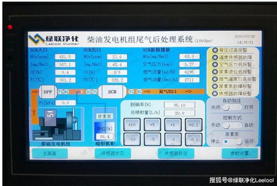
绿联净化 SCR 脱硝系统控制器界面，能够清晰的实时读取进气排气数据
