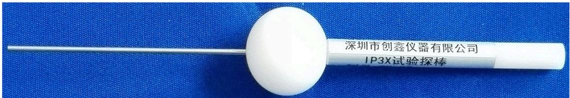
6、根据 IEC61032 图 3(Test probe C)、GB/T4208-2008 表 6（第一位特征数字 3）。
