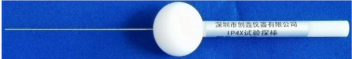
6、根据 IEC61032 图 4(Test probe D)、GB/T4208-2008 表 6 (第一位特征数字 4/5/6)。
