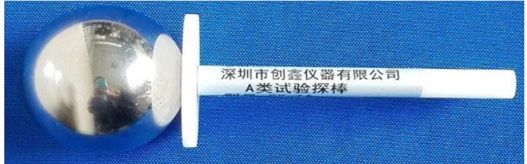
6、根据 IEC61032 图 1(Test probe A)、GB/T4208-2008 表 6（第一位特征数字 1）
